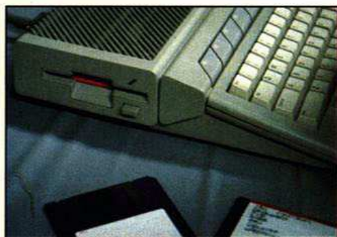
Atari präsentierte den 260 ST mit 254 KByte RAM und einer eingebauten 3 1/2-Zoll-Diskettenstation
